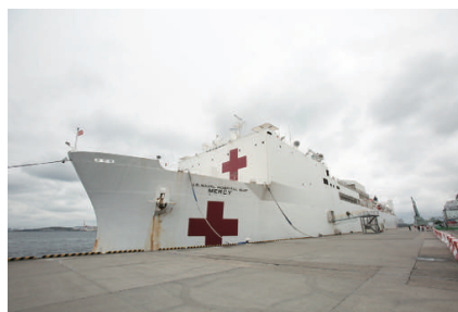
東京港大井水産物埠頭に接岸した米海軍病院船マーシー(撮影:Katsumi Hirabayashi) ・全長272.6m、全幅32.2m、排水量約7万トン ・就役1986年(古い石油タンカー「セント・ワース」を改造) ・入院病床1,000床、ICU 80床 ・手術室12室、レントゲン7機、CT撮影室1室、ダビンチ1機、殺菌室、薬剤室、歯科室、NBC災害洗浄室、遺体安置室、酸素発生室なども完備 ・日量7万トンの純水生産設備、酸素生産設備まで備え自己完結できる病院の船
